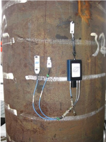
Bild 3: Sensoren mit Übertragungseinheit (Bluetooth) für kabellose Verbindung zum Messgerät – links für Jetty Nachrammung < 100 Schläge Sensoren bleiben zugänglich – rechts gesichert für Offshore-Einsatz ca. 4.000 Schläge
